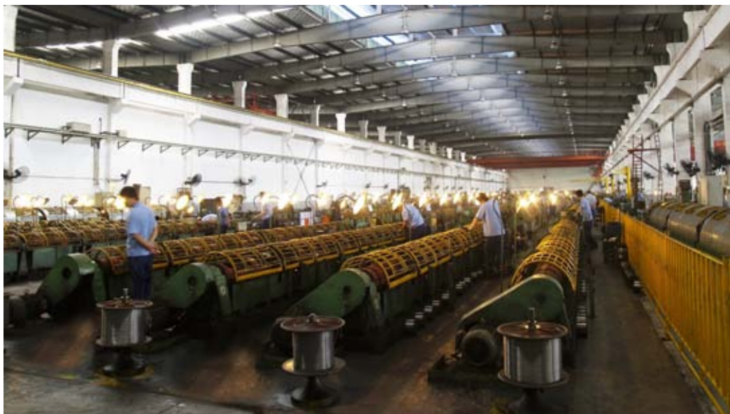
捻绳车间 Laying up
