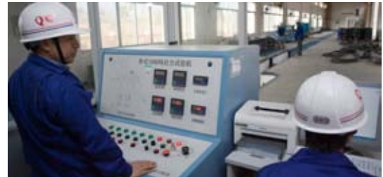
大吨位钢丝绳索具拉力试验 1000t tensile testing
